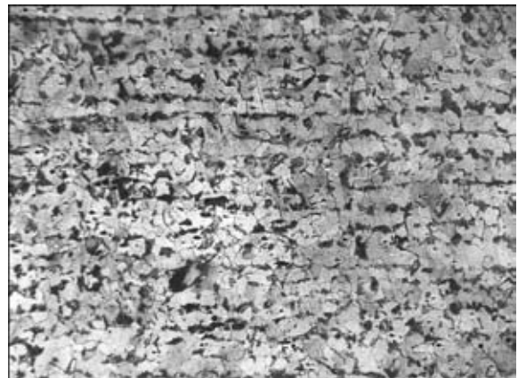
Рис. 1. Микроструктура (×200) стали 09Г2С в состоянии поставки
