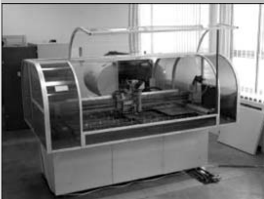
Общий вид комплекса для лазерной резки с компьютерным управлением
