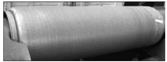
Рис. 2. Рабочий валок дрессировочной клетки после металлизации
