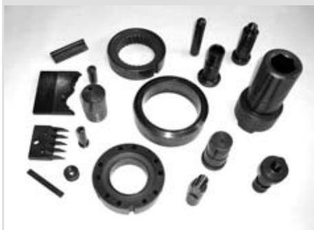
Детали с карбидным покрытием могут эксплуатироваться при температурах в случае карбида ванадия — до 400 °С, в случае карбида хрома — до 850 °С.
