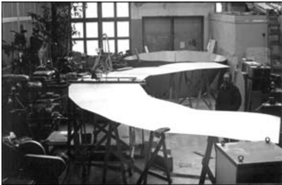
Рис. 11. Общий вид плоской заготовки конической оболочки на стапеле
