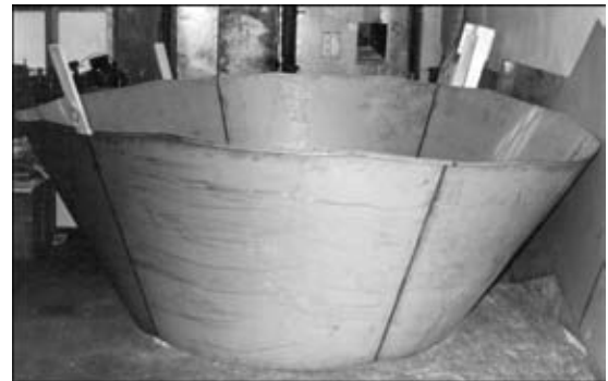
Рис. 13. Общий вид сварной конической оболочки перед формированием гофров
