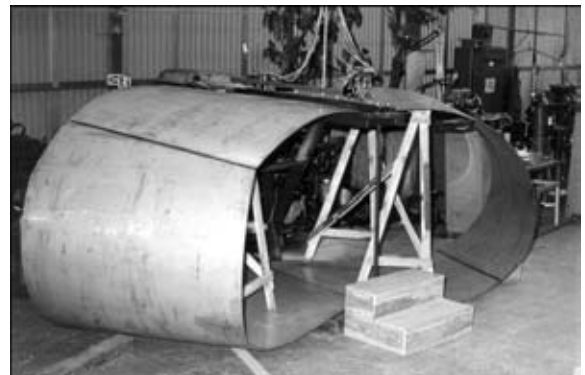
Рис. 12. Собранный под сварку замыкающий стык шва конической оболочки на стапеле
