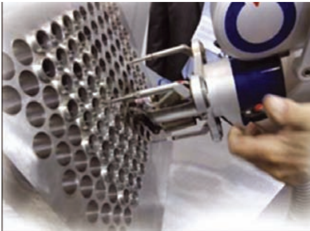
Применение головки для приварки трубы к трубной доске в теплообменниках
