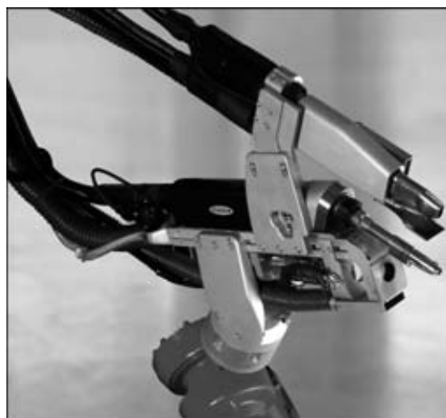
Рис. 2. Сварочный модуль (инструмент) для осуществления гибридной лазерной сварки МИГ/МАГ + сварка двумя последовательными дугами
