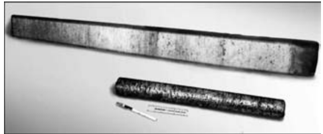
Рис. 1. Внешний вид сляба 140×160 мм и цилиндрического слитка диаметром 70 мм из быстрорежущей стали Р6М5 ЭППЕ
