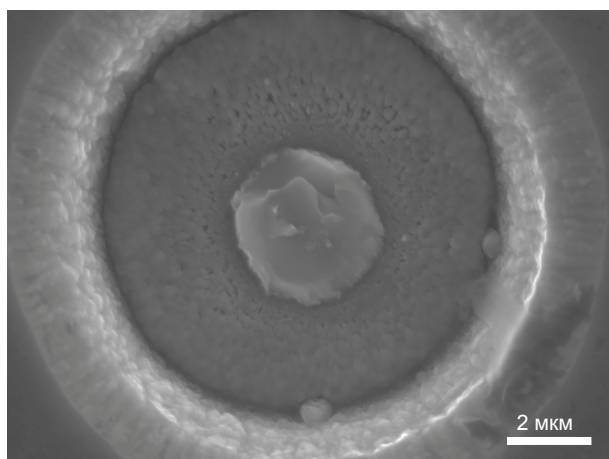
Рис. 4. Фрагменты поверхности покрытий, полученных на лицевой поверхности образца при давлении азота 0,66 Па. Потенциал поверхности — 300 В. Увеличение \times 3000 — а \times 10000 — б
