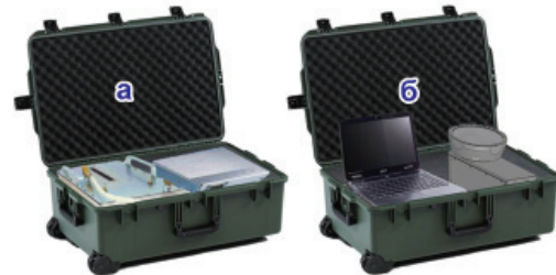
а - рентгеновский аппарат, б - детектирующее устройство и ноутбук
