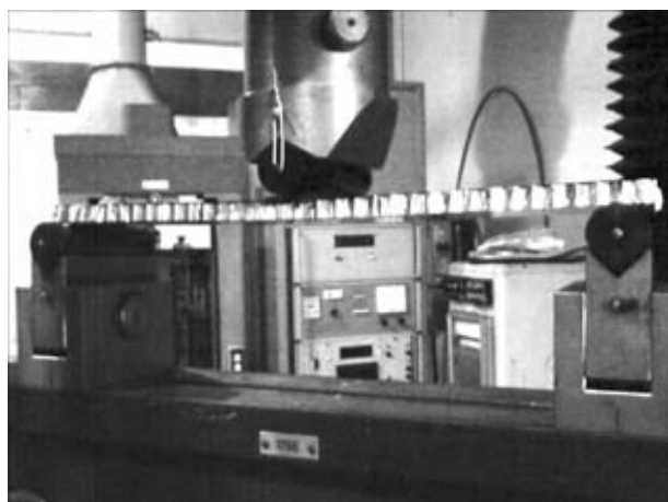
Рис. 2. Общий вид балочного образца при испытаниях на изгиб
