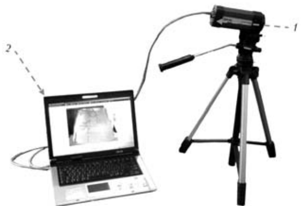
Рис. 5. Общий вид установки для теплового контроля: 1 — тепловизор; 2 — ЭВМ
