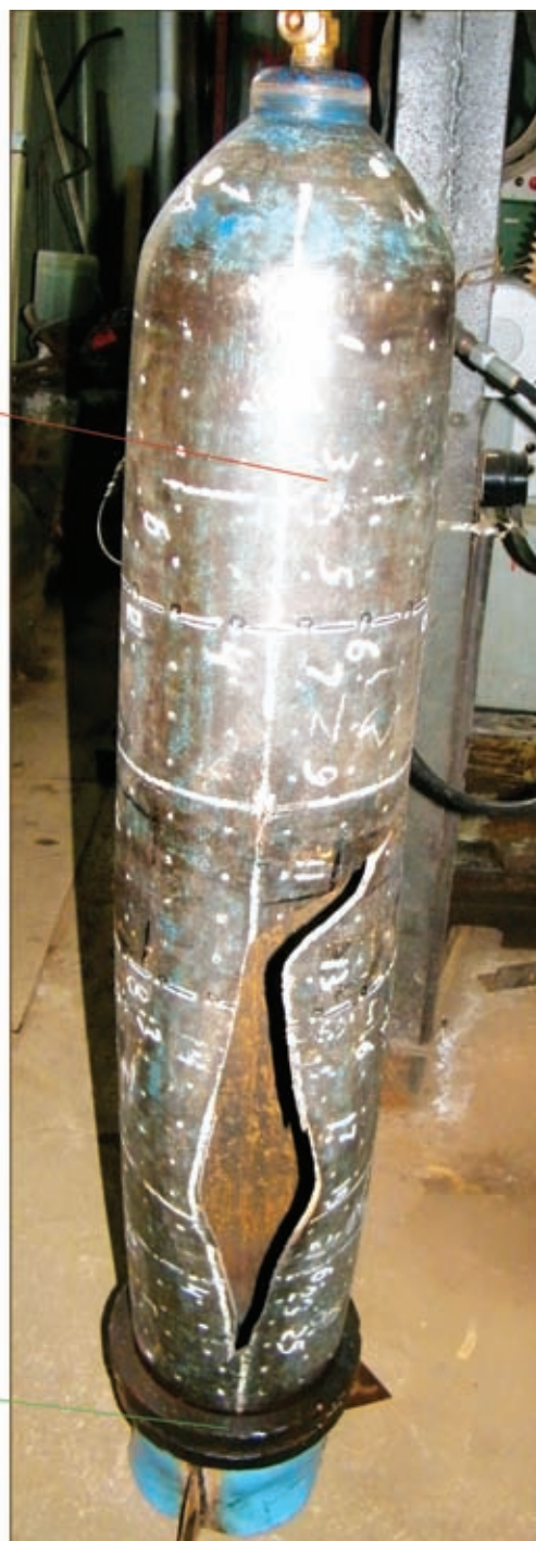
Рис. 2. Баллон Б1 с бандажом после гидравлического испытания статическим давлением 51,9 МПа; 1 — участок пробы из зоны с наибольшими значениями кольцевой деформации — 6...7 %; 2 — бандаж
