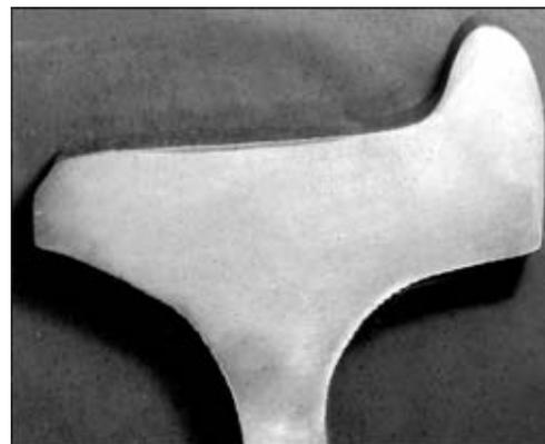
Рис. 1. Макрошлиф фрагмента колеса с изношенной поверхностью катания
