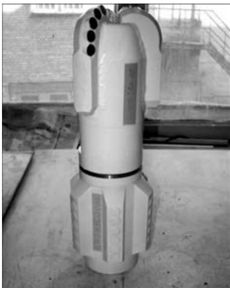
Рис. 5. Буровое долото с калибратором для поверхностного бурения скважин
