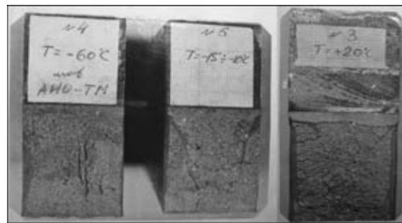
Рис. 2. Поверхность излома исследуемых образцов на трехточечный изгиб при разных температурах
