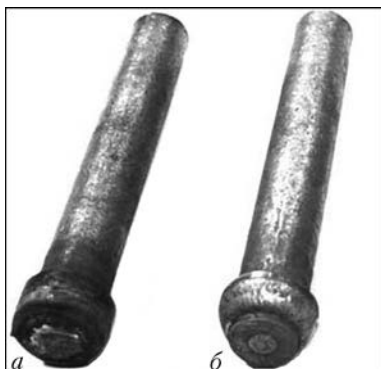
Рис. 5. Заготовки штоков вентилей DN 50, наплавленные ручным электродуговым (а) и плазменным (б) способами наплавки
