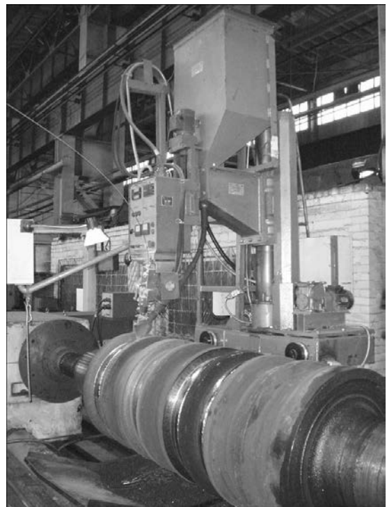
Рис. 4. Установка РМ-12 для наплавки прокатных валков
