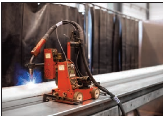
Работающая от аккумуляторной батареи тележка FDV 22 MF оснащена постоянным магнитом и предназначена для автоматической сварки прямолинейных швов способом MIG/MAG
