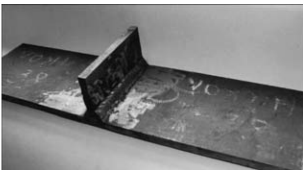
Рис. 1. Тавровый образец из стали 09Г2С для испытаний
