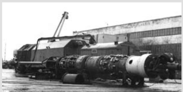
Контактная стыковая машина K700-1
