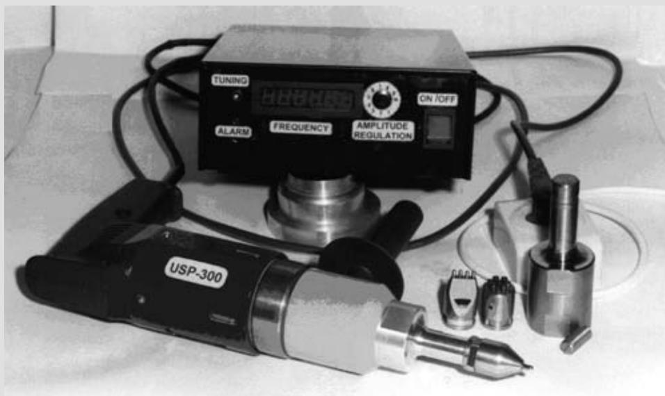
Для упрочнения сварных соединений в целях повышения сопротивления усталости при ВМП пластическому деформированию подвергается только зона сплавления шва с основным металлом шириной 4... 7 мм.
