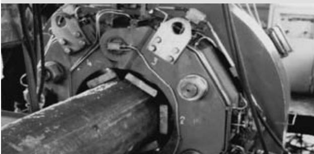
Контактная стыковая машина K805
