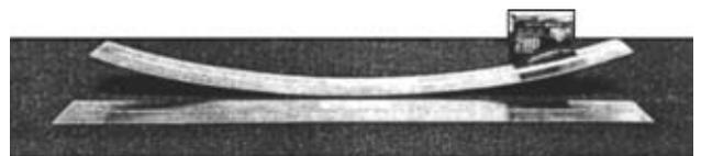
Рис. 3. Сравнение угловой деформации при СТП (нижний образец) и СПЭ (верхний) (алюминиевый сплав серии 6000, толщина 2 мм)
