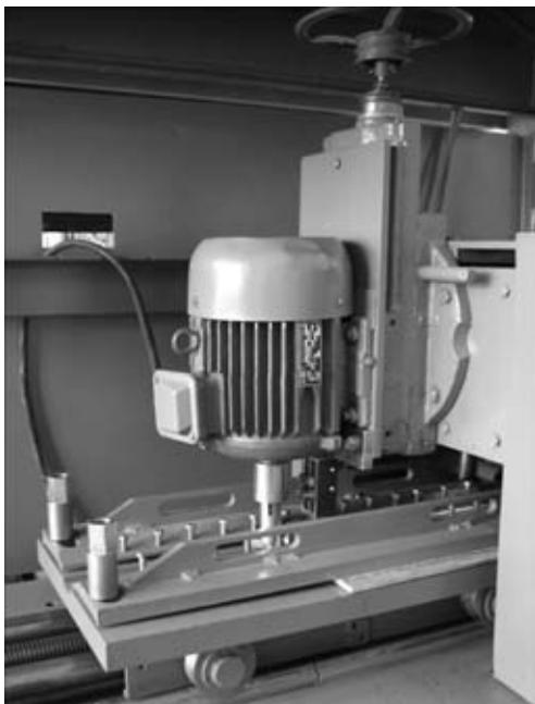
Рис. 15. Внешний вид экспериментальной установки для СТП тонколистовых (1,8...2,5 мм) алюминиевых сплавов
