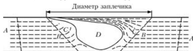
Рис. 4. Схема зон стыкового соединения, выполненного СТП (обозначения см. в тексте)
