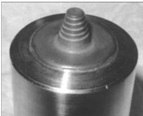
Рис. 8. Внешний вид инструмента из поликристаллического кубического нитрида бора [2]
