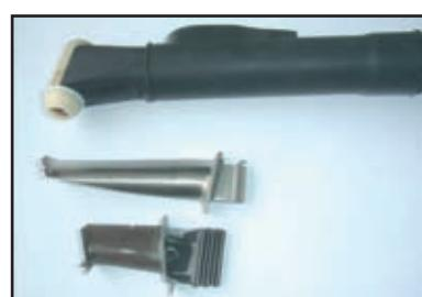
турбин, зиги бандажных полок лопаток турбин и т. д. Для этих целей разработан специальный плазмотрон, работающий на токах 3...50 А с возможностью формирования наплавочного шва сверхмалых размеров. Для наплавки будут использоваться оригинальные порошки Делоро Стеллит. Установки будут изготовлены предприятием Хеттигер Стеллит (Кобленц, Германия) и введены в эксплуатацию в Украине в четвертом квартале 2007 г.
