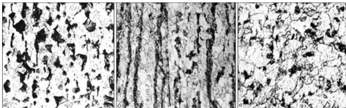
Рис. 2. Микроструктуры ( \times 500 ) исследуемых сталей: а — 15ХСАТЮД; б — 10Г2ФБ; в — 06ГБД
