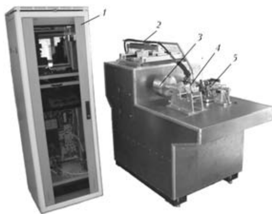
Рис. 2. Общий вид машины (МИС) для испытания на ГТ по стандарту РФ: 1 — блок управления параметрами испытания, их визуализации и регистрации; 2 — манипулятор сварочной головки для ее перемещения по x , y и x_y ; 3 — силоизмеритель; 4 — устройство для сварки образцов и их испытания на изгиб или растяжение; 5 — устройство для имитации сварочного цикла в образцах и испытания на ГТ в стадии охлаждения
