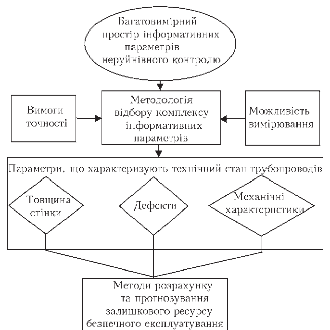
Рис. 3. Проблема методології підбору комплексу інформативних параметрів контролю технічного стану трубопроводів
