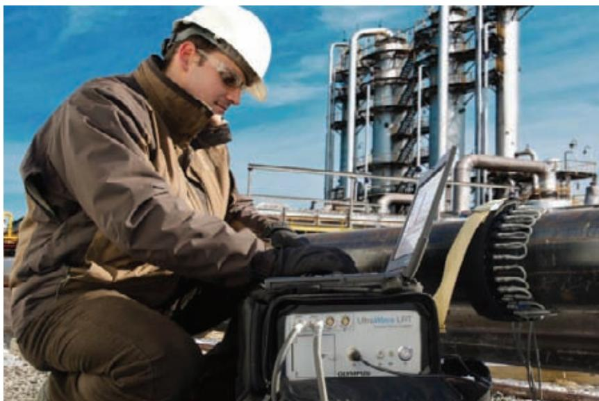
поперечного сечения. Так как потеря энергии минимальна, волны могут распространяться на большие расстояния, гарантируя 100%-ый охват поверхности трубы без перемещения датчика. Фокусирование волн на дефектных зонах повышает эффективность коррозионного мониторинга.
