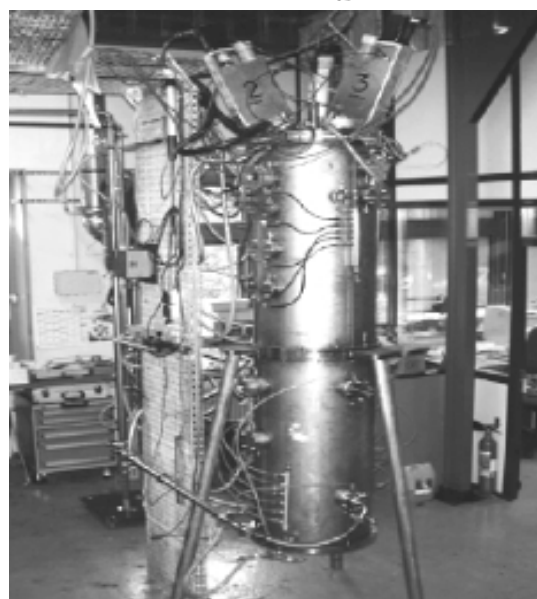
Рис. 9. Схема установки с 3-х фазным дуговым плазматроном (а) и ее фотография (б).
