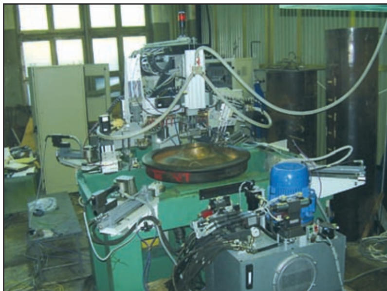
Станция НК364 АУЗК железнодорожных колес
