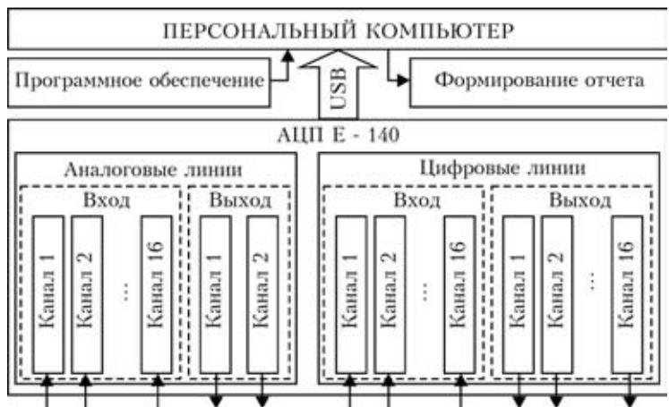
Рис. 2. Функциональная схема ИИС
