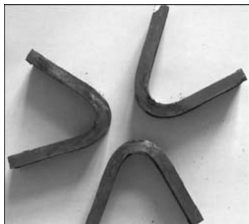
Рис. 3. Результаты испытаний сварного соединения на изгиб
