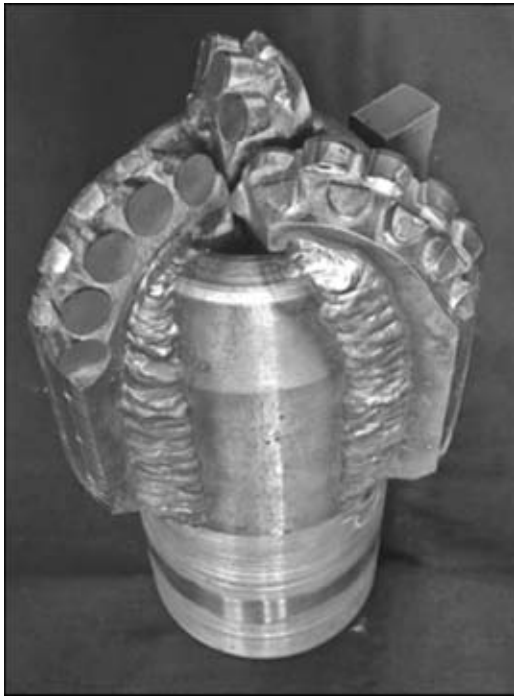
Рис. 6. Буровое долото, оснащенное АТР
