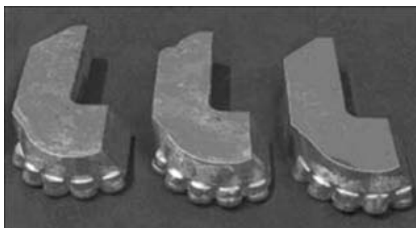
Рис. 5. Лопasti буровых долот с паянными АТР
