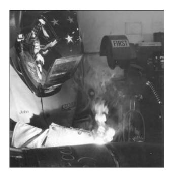
проплавления по всей толщине свариваемого металла. Система ProPulse  $^{\mathrm{TM}}$  обеспечивает поддержание оптимального значения сварочного тока и напряжения в зависимости от типа и диаметра присадочной проволоки, скорости подачи проволоки и состава газовой защиты.
