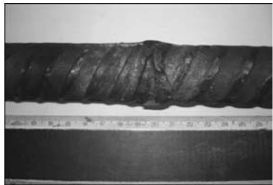
Рис. 3. Внешний вид сварного соединения арматуры диаметром 32 мм из стали 25Г2С
