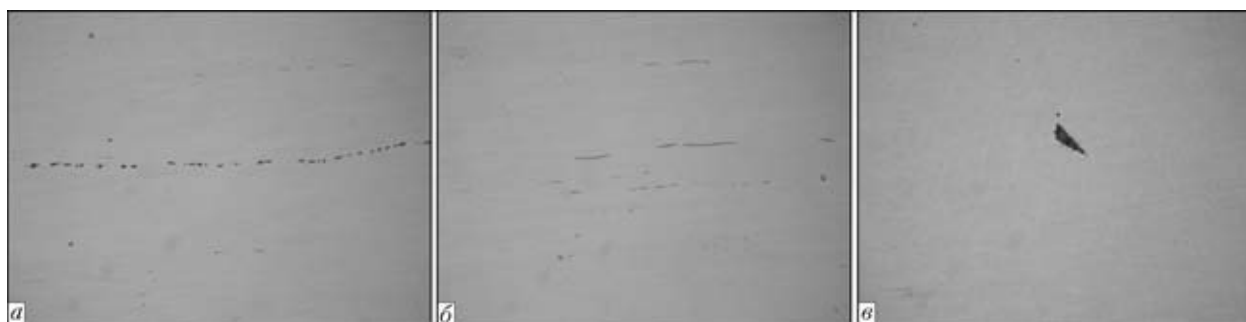
Рис. 2. Микроструктуры (×500) ОМ и металла шва с неметаллическими включениями в них: а — цепочки оксидов в ОМ вдоль проката; б — сульфиды в ОМ, вытянутые вдоль проката; в — включения корунда и силикатов в однопроходном металле шва
