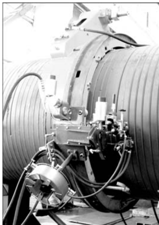
Рис. 3. Сварочный аппарат комплекса «Стык» нового поколения для автоматизированной электродуговой сварки порошковой проволокой с принудительным формированием шва неповоротных стыков труб большого диаметра (производитель — ОАО «Каховский завод электросварочного оборудования»)
