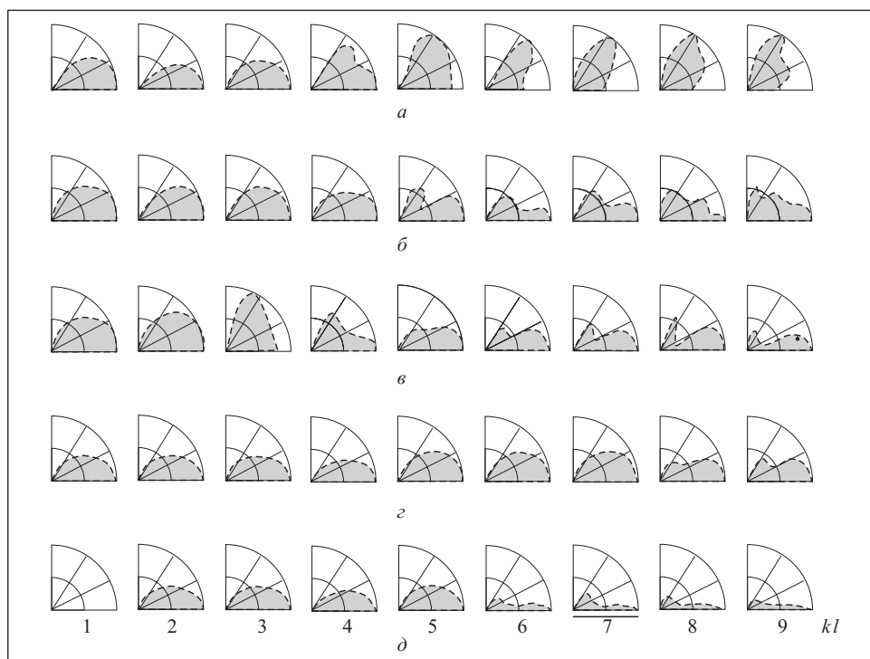
Рис. 5. Внешние характеристики НКВ: a — узкий при 2\Psi = 40^\circ ; b — средний при 2\Psi = 80^\circ ; c — широкий при 2\Psi = 120^\circ ; z — узкий при 2\Psi = 42^\circ с вынесенной точкой возбуждения; d — широкий при 2\Psi = 98^\circ с вынесенной точкой возбуждения
