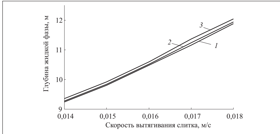
Рис. 7. Глубина жидкой фазы в зависимости от скорости вытягивания слитка при различных режимах охлаждения: 1, 2, 3 — соответствующие режимы расхода воды
