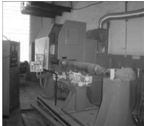
Рис. 3. Общий вид установки КТ-088 для восстановления шейки и подступичной части оси колесной пары способом плазменно-дуговой металлизации
