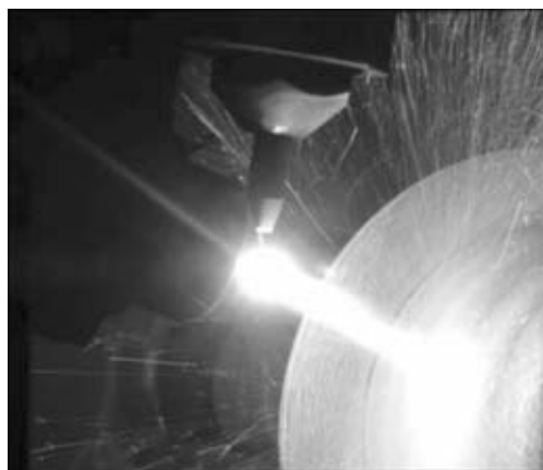
Рис. 4. Процесс плазменно-дуговой металлизации шейки оси
