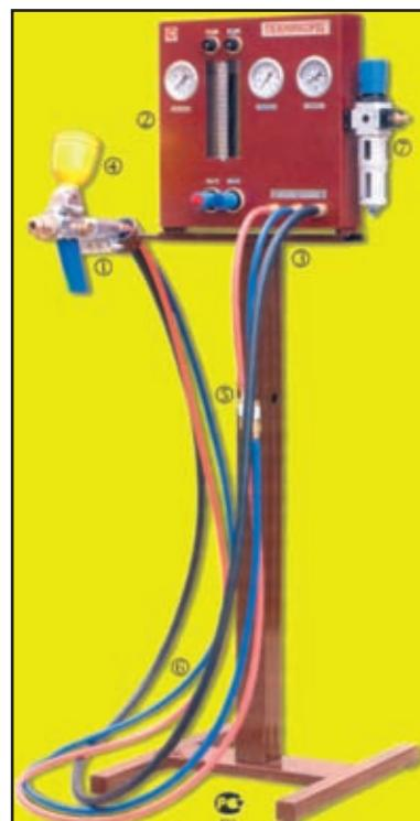
управления 2 рабочими газами ПУ-03, смонтированный на стойке 3. На пистолете-распылителе предусмотрено крепление для установки бункера 4 — дозатора порошка. Пистолет-распылитель соединяется с пультом управления рабочими газами через защитные клапаны-пламегасители 5 резинотканевыми рукавами 6 с разъемами для кислорода, горючего газа (ацетилена, пропана или МАФ) и сжатого воздуха.
