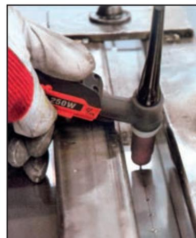
В частности, при сварке тонких заготовок велика вероятность прогорания прихваток, они также могут получаться выпуклыми или бугристыми, что приводит к дефектам качества конечного продукта. В то же время чрезмерное тепловложение на этапе выполнения прихватки может привести к искривлению заготовок и образованию между ними воздушных зазоров.
