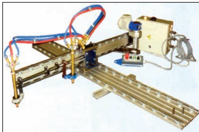
резаки. Машина может оснащаться любым аппаратом для воздушно-плазменной резки металлов марки ПУРМ, а также оборудованием для газокислородной резки. Машина выполнена на современном уровне с использованием лучших образцов приводной техники.
