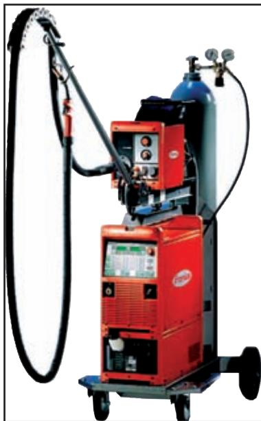
комплектуется механизмом подачи VR 3000 открытого типа с возможностью более простой и быстрой замены бобины с проволокой. При работе в особо стесненных условиях и для стабильной подачи трудноподаваемых Al и CrNi проволок на расстояние более 5 м аппараты комплектуются горелкой Pull-Mig «Тяни/Толкай» со встроенным механизмом подачи проволоки.
