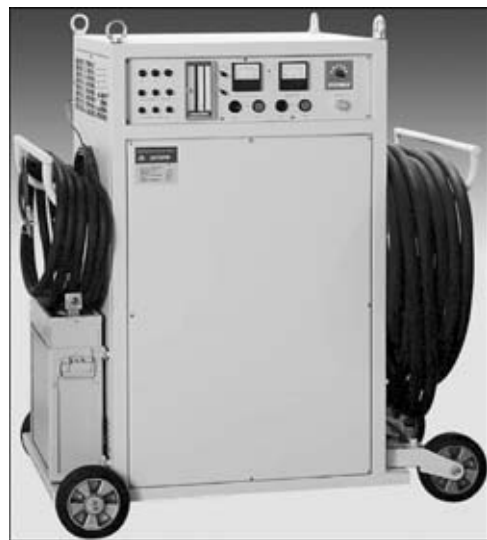
Рис. 6. Общий вид установки индукционного нагрева «ЭЛ-ТЕРМ-С УИИТ-50-2,4»
