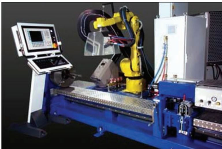
Установка Jet Kote для сверхзвукового напыления
