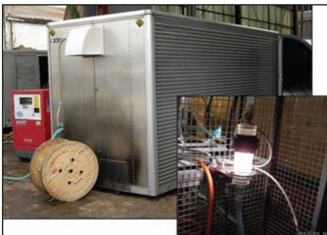
Общий вид мобильной плазменной установки для очистки радиоактивной воды
