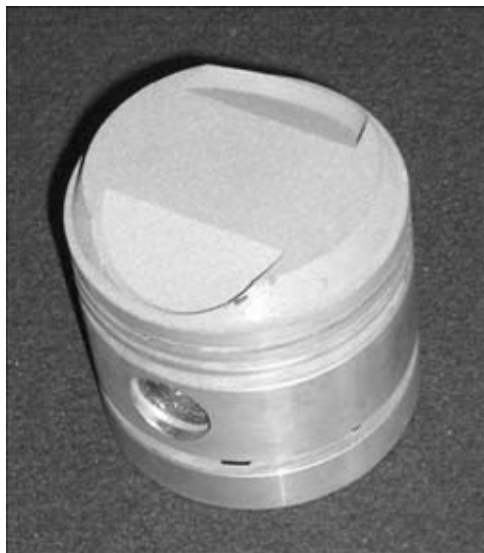
Рис. 7. Поршень из алюминиевого сплава с теплозащитным покрытием
