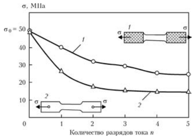
Рис. 2. Влияние конструктивных особенностей крепления образцов сплава АМг6 на снижение напряжений \sigma при ЭДО: 1 — крепление клиновыми захватами; 2 — то же, но П-образными скобами
