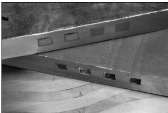
Рис. 2. Фрезерованные пластины с каналами для охлаждения водой
