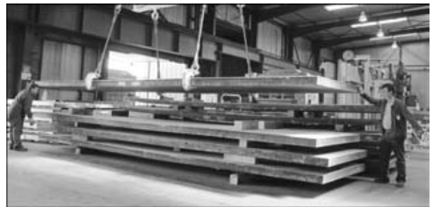
Рис. 1. Плакированные взрывом плиты титан (10 мм) + сталь (117 мм) размером 2200×8000 мм
