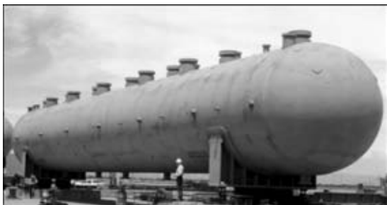
Рис. 5. Плакированный титаном автоклав (диаметр 5100 мм, масса 100 т) для извлечения никеля и кобальта из латеритных руд в кислой среде под давлением
