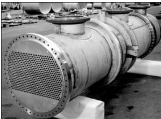
Рис. 7. Оболочечно-трубный теплообменник с циркониевыми трубами, кожухом из нержавеющей стали и трубными досками (сталь-цирконий), применяемый при производстве азотной кислоты
