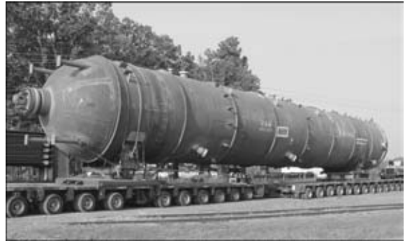
Рис. 4. Реактор для гидрогенизации (диаметр 4500 мм, масса более 1000 т), плакированный нержавеющей сталью
