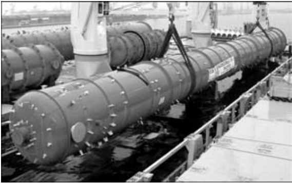
Рис. 3. Плакированная титаном колонна (диаметр 5000 мм, масса 450 т) для изготовления ОТК
