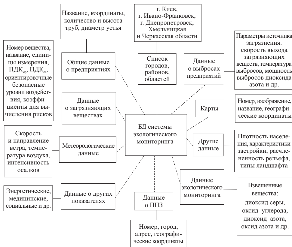
Рис. 1. Структурная схема БД системы эколого-энергетического мониторинга
