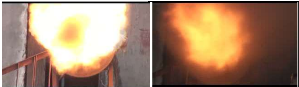
Рис. 4 – Фотографии факела горения водоугольного топлива
