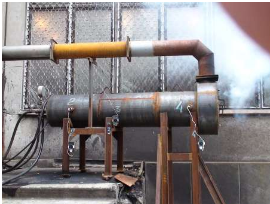
Рис. 8 – Фотография горелочного устройства, подготовленного к огневым испытаниям
