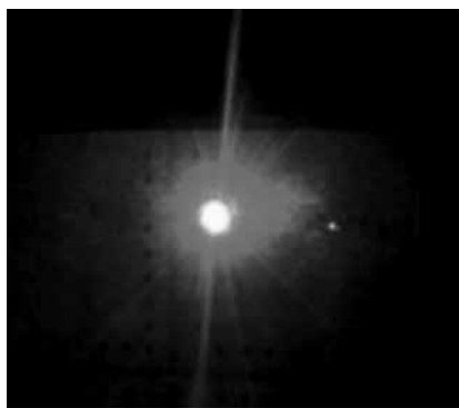
Рис. 3. Картина дифракции светового пучка на объемной акустической волне, возбужденной ВШП, соответствующая конфигурации рис. 1, а (в центре — световой пучок нулевого порядка, справа — дифракционный луч)
