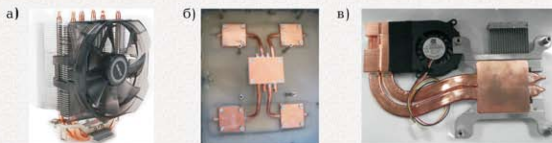
Системы охлаждения на основе медных микро- и миниатюрных ТТ: а — активная система охлаждения процессора CNPS8X OPTIMA компании ZALMAN [10] с тремя ТТ для компьютера класса десктоп; б — пассивная система охлаждения процессора видеорегистратора с четырьмя ТТ [12]; в — активная система охлаждения процессора компьютера класса лэптоп с двумя ТТ (использованы сплюснутые ТТ)
